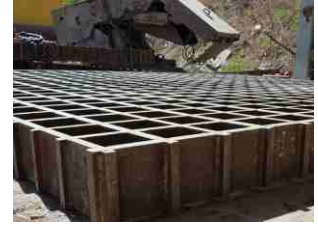
Bunker Izgara Eleği
